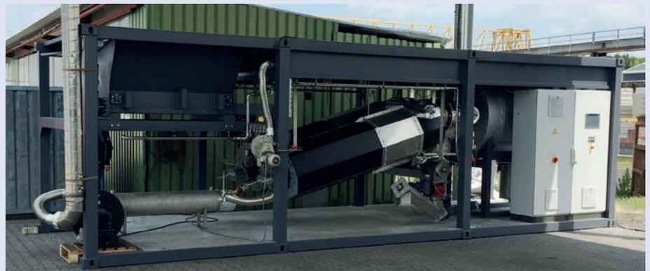
*Die neue Pyrolyseanlage, ein zentrales Element des energetischen Konzeptes der Deponie, verarbeitet unter anderem Grünschnitt, unbehandeltes Holz und Pferdemit zu Pflanzenkohle.*
